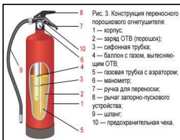
Рис. 1. строение огнетушителя.
