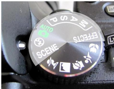
Эти режимы меняют алгоритм работы электронно-механической вычислительная системы, для каждого из них заданы диапазоны изменения параметров светочувствительность, диафрагма и выдержка, добавлена обработка изображения фильтрами, цветокоррекция кадра перед записью на флешку. Например:
