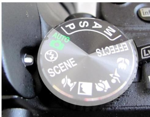
**Режим P (гибкий программный режим)** - этот режим рекомендуется использовать для моментальных снимков или когда возникает необходимость доверить фотокамере определение параметров выдержки и диафрагмы.
